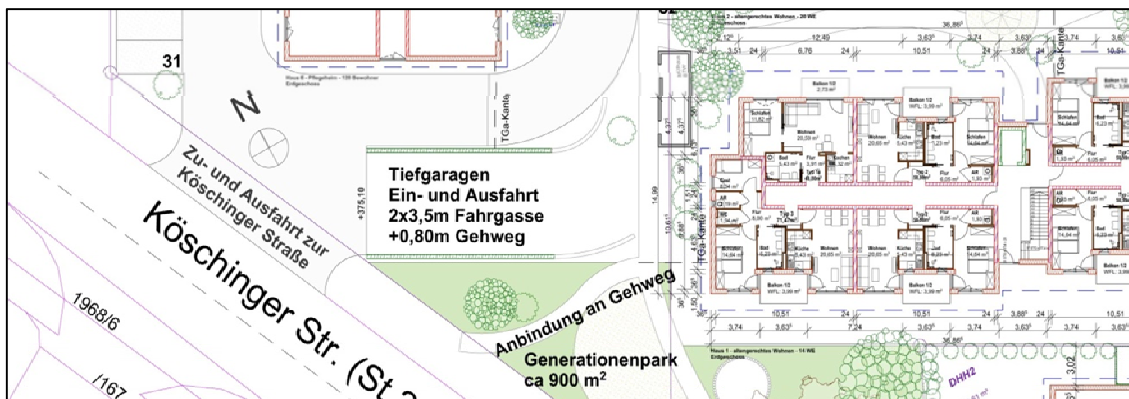
Abbildung 11: Grundriss Erdgeschoss mit Darstellung der Tiefgaragenrampe /66/
